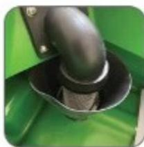
مجهز به شناور قطع کن مجرای مکش که در زمان پرسیدن مخزن آب، کلیف، سرمه، جزوگیری از ورود آب به داخل موتور و در نهایت پوسیدن آن من گردید.
