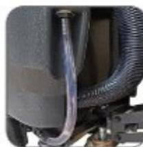
مجهز به تغییرگر میزان سطح آب تمیز داخل مخزن که سبب افزایش آگاهی از از اسکو از سطح عملکرد دستگاه می گردد.
