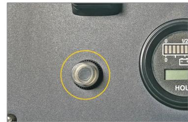
مجهز به فیوز فشنگی چهت قطع جریان برق به هنگام افزایش جریان موتورها که موجب جلوگیری از آسیب دیدن موتورها می گردد.
