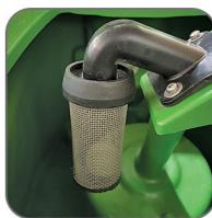
تجهیز به شناور قطع کن مجرای مکش که در زمان پر شدن مخزن آب کثیف سبب جلوگیری از ورود آب به داخل موتور و در نهایت پوسیدگی آن می‌گردد.
